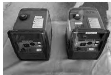
ガソリンによりエンジンを作動させて電気を発生させる。
