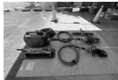
エンジンポンプまたはハンドポンプで加圧したオイルにより、機器を作動させる。「押し広げ」「切断」「押し上げ」「引張り」などの作業ができる。
