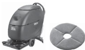
微振動の洗浄機構により、セラミックタイルの細孔に入り込んだ汚れを効果的に除去する、20インチタイプの自走型自動床洗浄機。鏡面、凹凸のセラミックに対応可能で、目地の洗浄汚水を確実に回収する優れたバキューム性能を有する。巾木付近やコーナー部分も汚水を飛散させることなく、洗浄可能。
