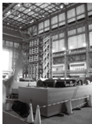
実験室 20分の1の建物が架台に取り付けられている。
