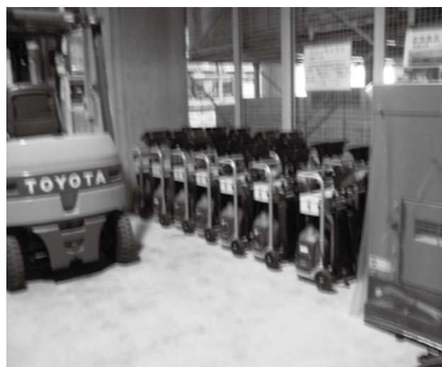
発電機付投光機
