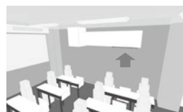
ダクト 横引 吸込口 下部
