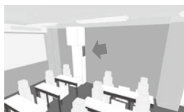
ダクト 縦 吸込口 上部
