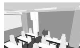
ダクト 縦 吸込口 下部
