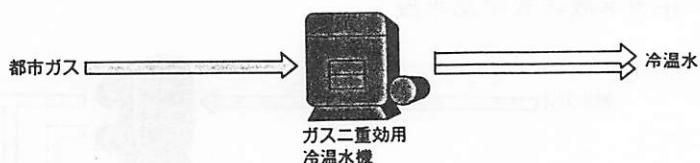
一般ビルに普及している冷暖房システムで、冷温水供給をするシステムです。信頼性が高く、中小規模の地域冷暖房や複合大規模ビルに適用できます。給湯需要の少ない事務所ビルなどが多い地域に適しています。
